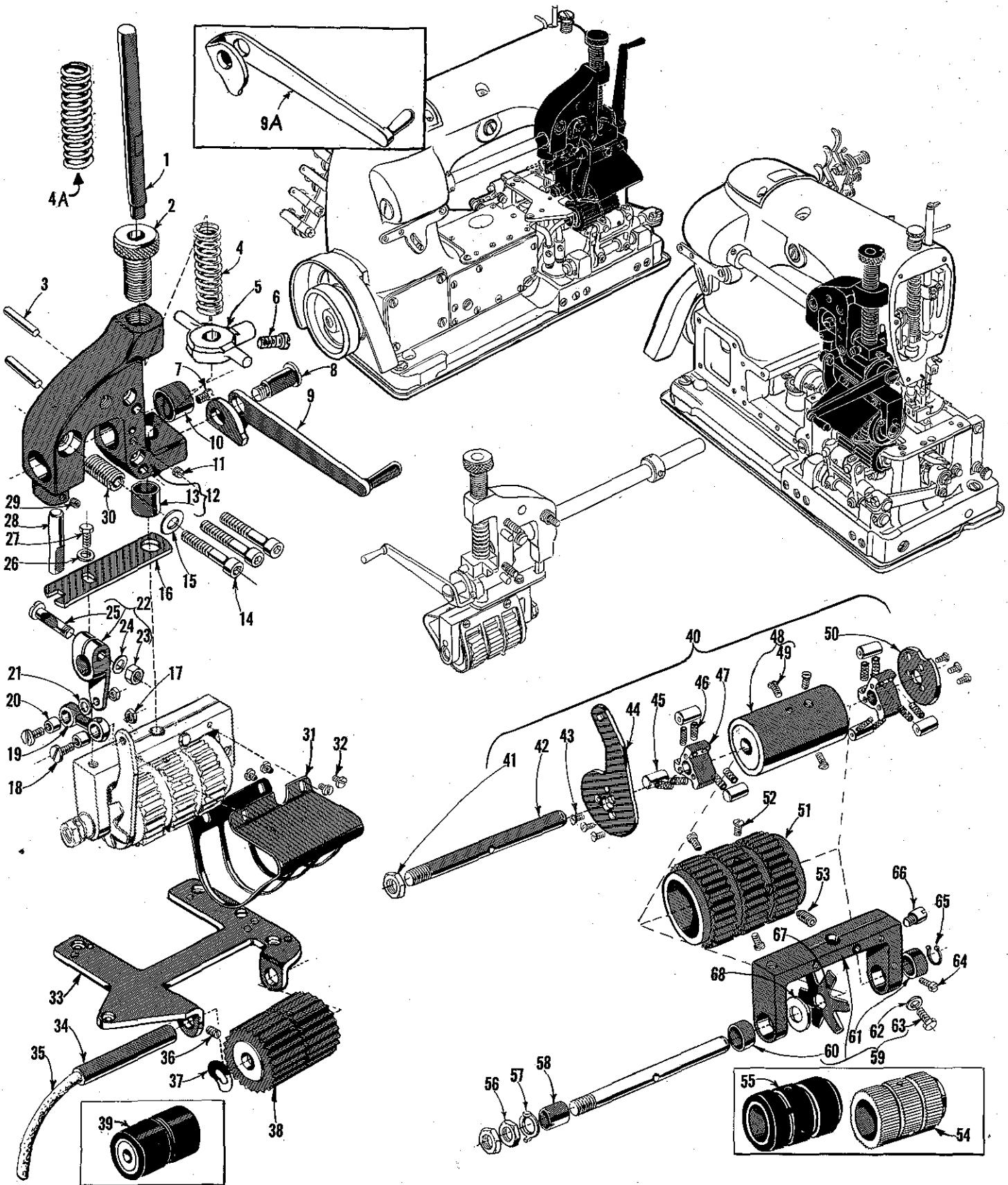
FEED ROLLER AND PULLER CLUTCH PARTS
